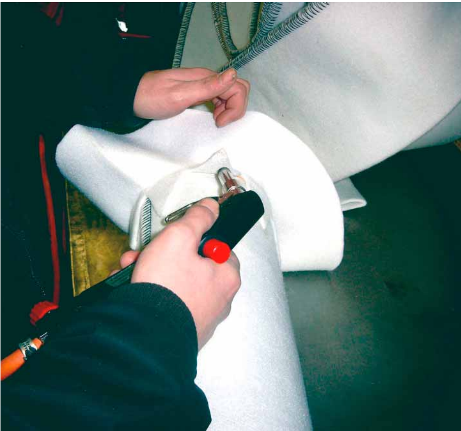
Abb. 3: Herstellen eines Hutprofil - Rohlings aus Synthefaser [Insituform Rohr-sanierungstechniken]
