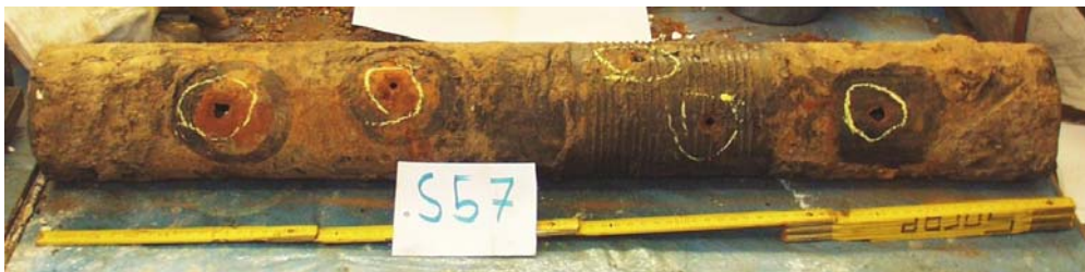
Bild 1: Stahlrohr mit mehreren Schäden durch Lochkorrosion – Reparieren, Sanieren oder Erneuern?
