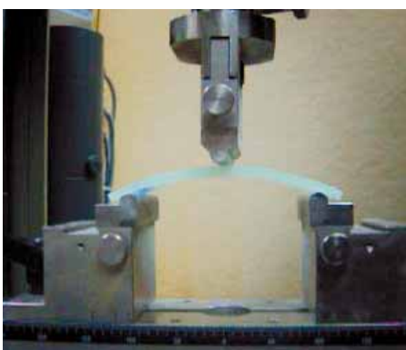
Abb. 4: Dreipunktbiegung DIN EN ISO 178
